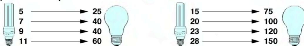
Figure 32 : Les lampes fluocompactes de substitution
